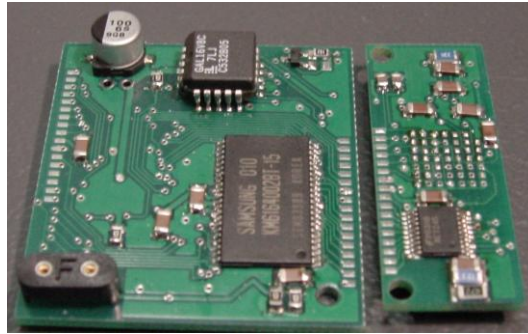
Abbildung 13.2: Bildverarbeitungs-DSP (Unterseite) mit Kamera-Sensor
