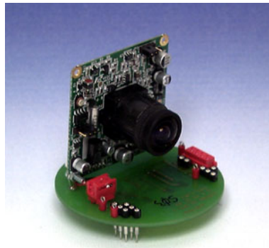
Abbildung 3.6: Khepera Kameramodul (Quelle: K-Team)
