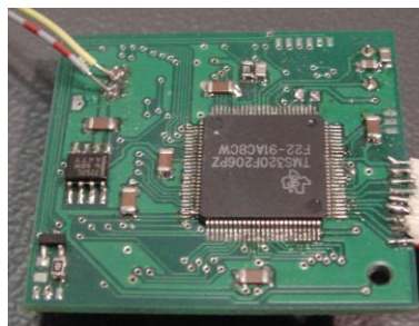
Abbildung 13.1: Prototyp des Bildverarbeitungs-DSPs
